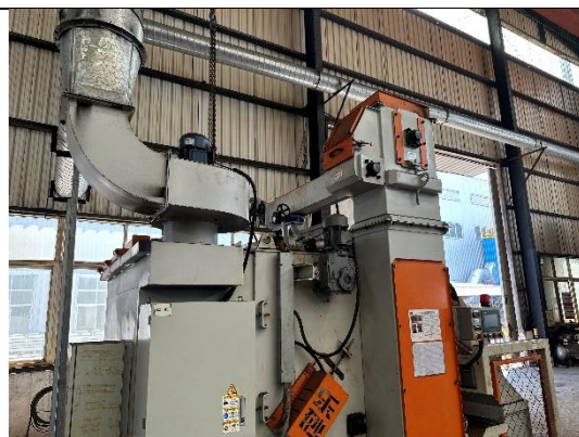
一车间抛丸机 2 及除尘器
